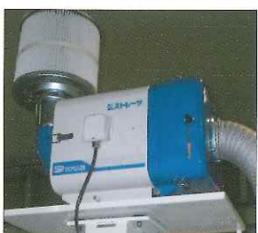
オイルミストコレクター(オプション) Oil mist collector (option)
