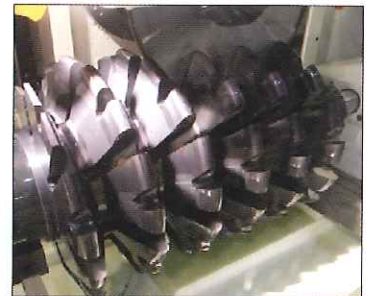
大径φ250CBN砥石によるEZホブ研削 Grinding of EZ Hob with φ250 CBN wheel
