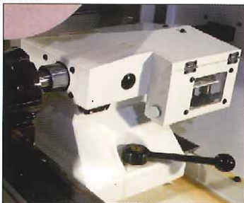
大径ホブ対応油圧テールストック Hydraulic clumping tailstock center
