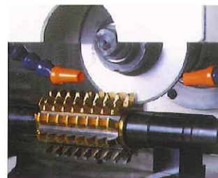
CBN砥石によるストレートギャッシュホブの研削 Grinding of straight gash hob with CBN wheel
