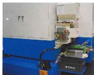
オイルミストコレクター/マグネットセパレーター/標準タンク Oil mist collector, magnet separator and standard coolant tank
